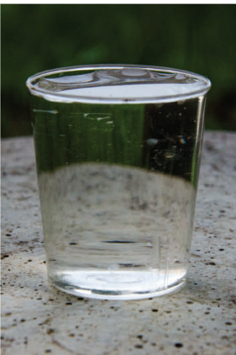
Vzorec vzet iz odtočne posode - po fazi sedimentacije se preko odtočne posode vrši praznjenje glavne posode (prečiščena voda zapusti malo čistilno napravo)
